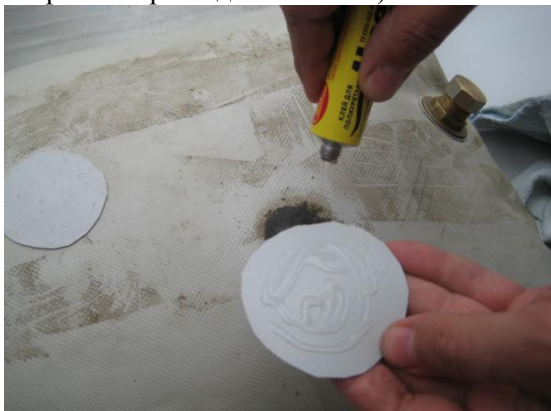
Нанесение клея «Уран» на кусочек полимерного материала
