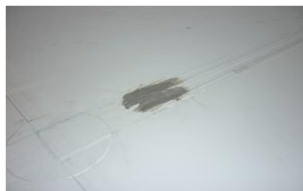
Пример использования «пластилина для ремонта топливных баков»
