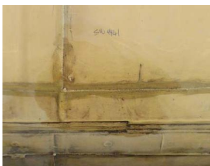
Пример допустимой диффузии в ткани. В результате диффузии на ткани образуются кольца.
