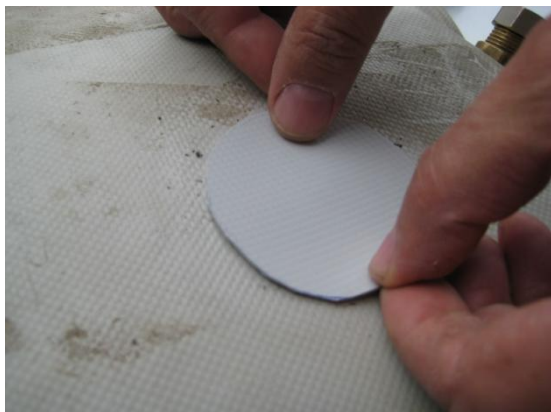
Накладываем и прижимаем кусочек полимерного материала
